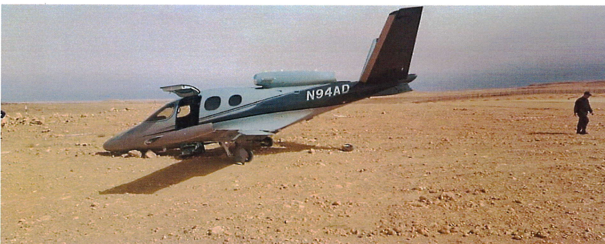
Figure n° 03 : Trois (03) photos de l'avion, de type SF 50 immatriculé 94AD prises le 24 février 2024, après sa sortie de piste 18. Roulette de nez détachée.
