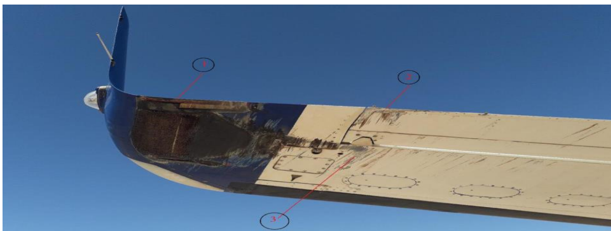
Figure 8- Partie de l'aile gauche endommagée du B1900D
