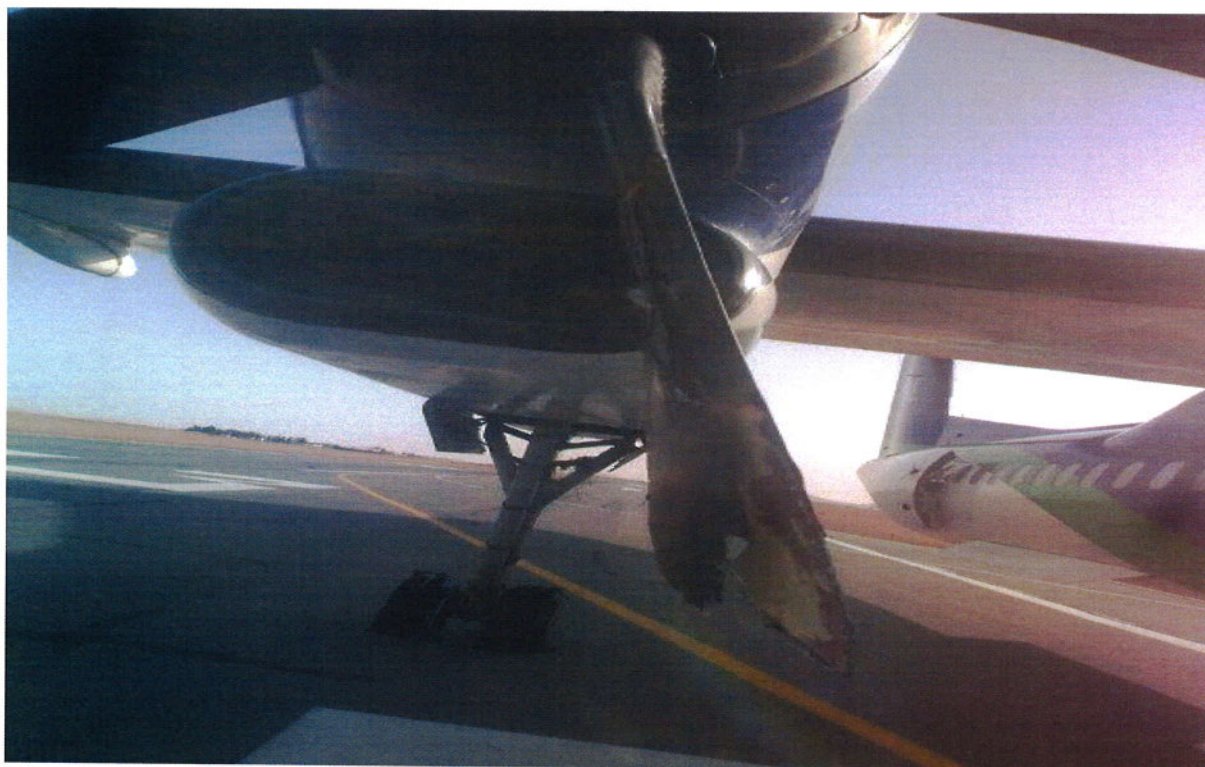
Photo n°04 hélice du moteur n° 02 côté droit du DHC-8-402 immatriculé 7T-VCL endommagé.
