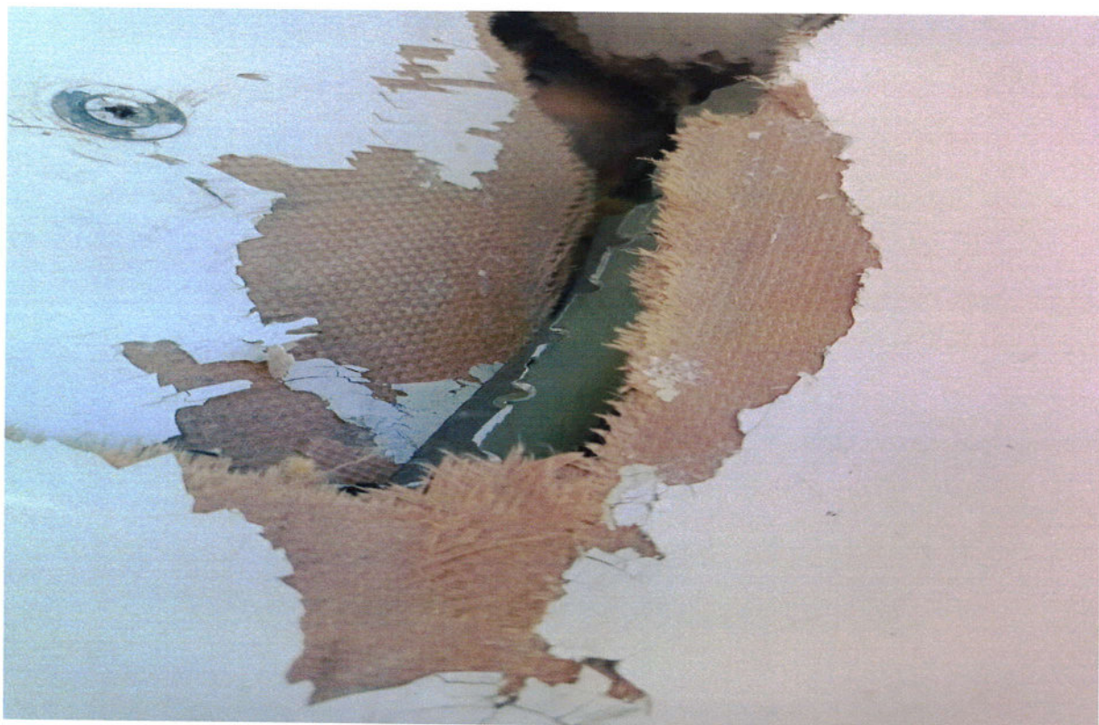
Photo n° 05 Fuselage côté droit du DHC-8-402 immatriculé 7T-VCL endommagé
