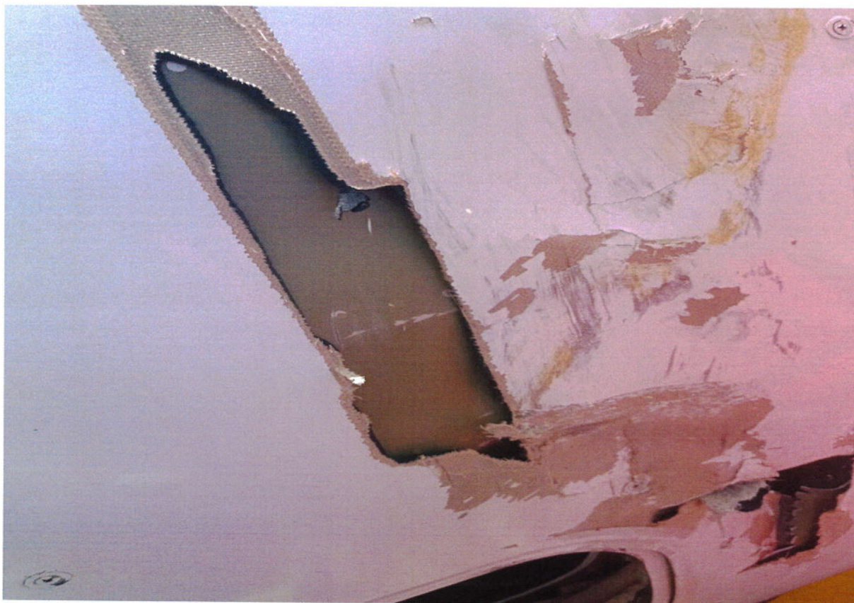
Photo n° 06 Fuselage et hublot côté droit du DHC-8-402 immatriculé 7T-VCL endommagés.
