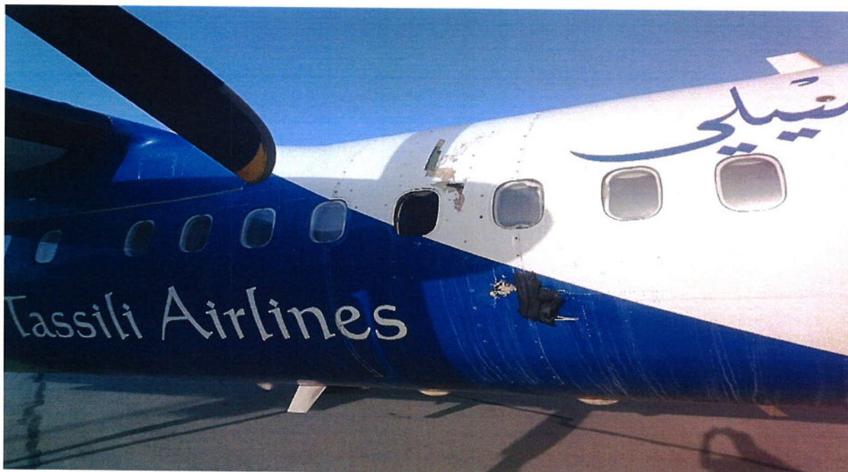
Photo n° 02 Fuselage et un hublot côté droit du DHC-8-402 immatriculé 7T-VCL endommagés.
