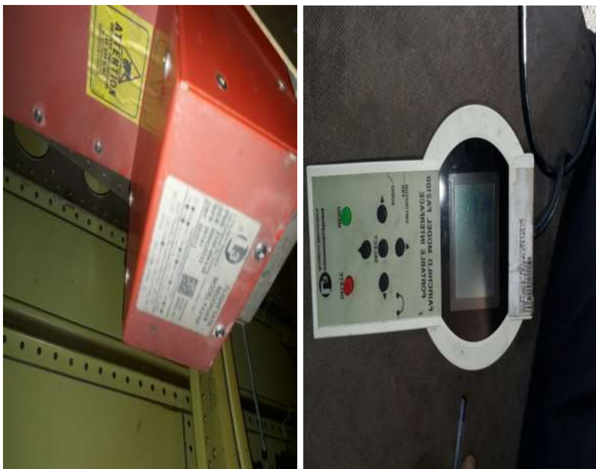
Figure n 02: Opération de téléchargement de l'enregistreur de paramètres de vol (FDR).
