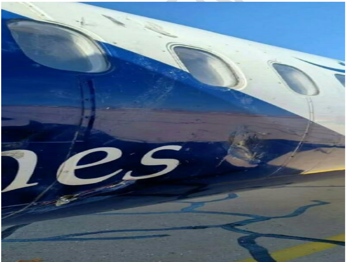
Figure n°10 : Fuselage DASH8-402 endommagé.
