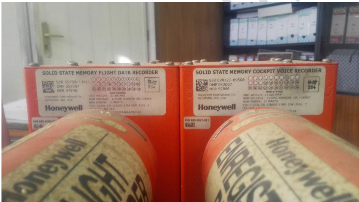
Figure n°4 : enregistreurs de paramètres de vol (FDR) et phonique (CVR)
