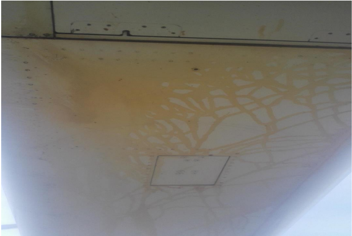
Figure n°11 : Traces d'huiles visibles en dessous du moteur droit du DASH8-402
